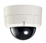
最大解像度 1920X1080/30p EX-SDI/HD-SDI/CVBS(設置時確認用) 最低照度0.025 lux(白黒DSS) 2.8~10mmメガピクセルレンズ ノイズリダクション 2D+3D リアルタイムTrue WDR 高出力赤外線LED4個搭載 照射距離最長50m IP66、IK10
