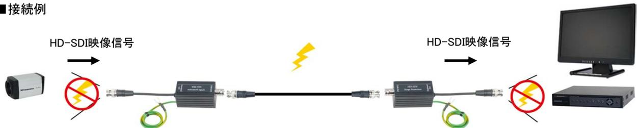
サージプロテクター間に使用する同軸ケーブルおよびBNCコネクタは、インピーダンス75Ωの高品質のものをご使用ください。さもないと、信号ロスや伝送品質の低下などを招く恐れがあります。
