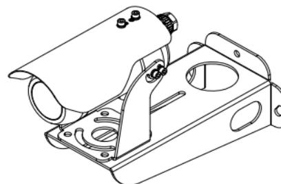
※壁面に固定する場合、ケーブルの曲がりの関係上、ウォールブラケットでの設置が必要です。
