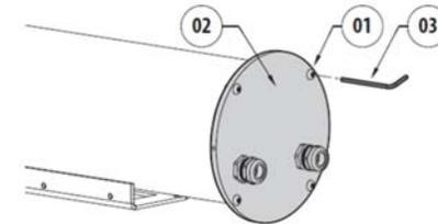
背面フランジをハウジング本体からスライドして抜きます。密閉用の O リングが取れないように気をつけてください。
