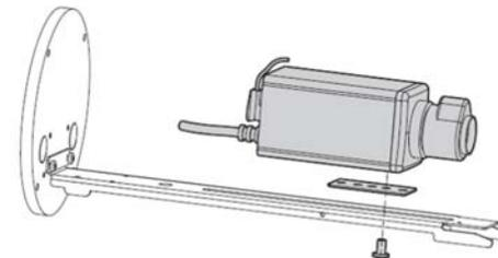
カメラ用の映像ケーブル・電源ケーブルの配線を確認し、ケーブルグランドから引き込みます。ハウジング内ではケーブルに負荷がかからないよう少し余裕を持た
