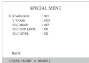
揺れ補正機能の ON/OFF を設定します。
