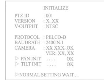
カメラの電源を入れます。電源投入後、カメラシステムの初期駆動に 10 秒ほどかかります。パン(水平)・チルト(垂直)・上・下方向に駆動し、レンズのフォーカス調整後、停止します。起動中に下図のとおり、カメラ ID、プログラムバージョン、制御通信プロトコル、ポーレートなどの情報を確認できます。
