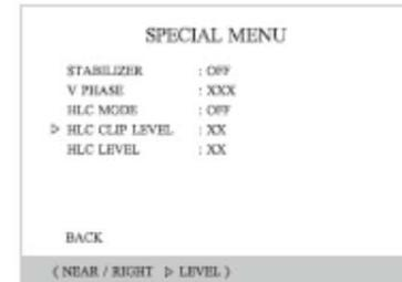
HLC を ON に設定した場合、クリップレベルを設定します。0~6 の範囲で選択できます。
