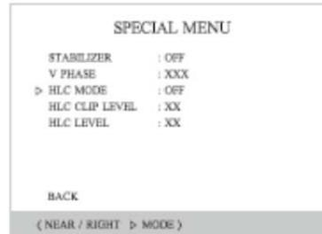
ハイライト補正機能の ON/OFF を設定します。暗い場所に著しく強い光がある場合、マスクをかけハレーションを抑えます。
