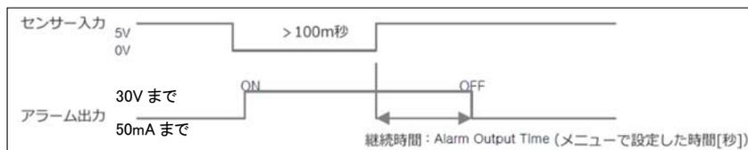
注) アラーム接続に適正なアラームコネクタを使用してください。また、記載の入力/出力電圧を使用してください。さもないと誤動作する場合があります。
