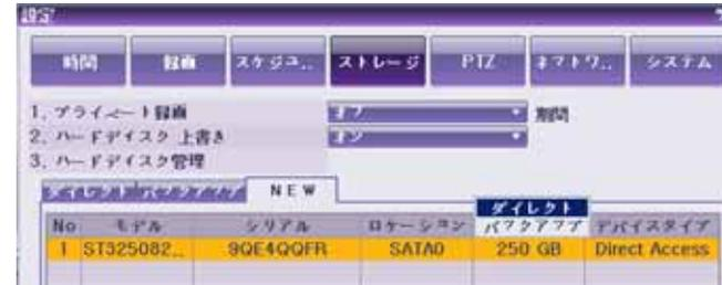
ダイレクト 選択した保存装置をダイレクト記録用に設定します。
