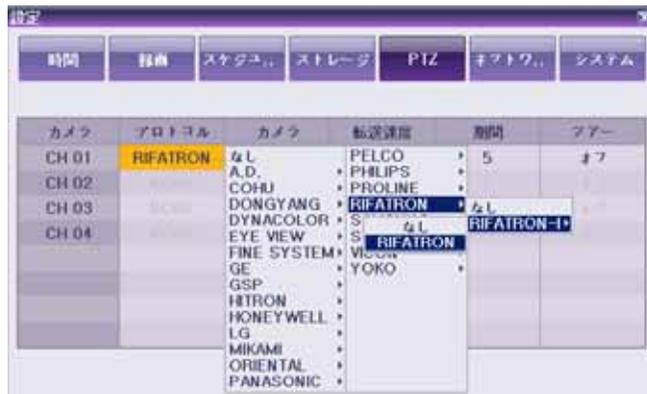
方向ボタンと選択ボタンを利用して、設定するチャンネルのカメラの PTZ プロトコルを選択します。22 社の PTZ カメラに対応しています。選択画面表示後、使用する PTZ プロトコルを選択します。
