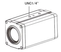
正立、天吊り等設置環境に合わせて、適正な金具で固定します。 金具はカメラの重量の 4 倍以上の耐荷重の製品を使用してください。 適合するブラケットや、収納用のカメラハウジングなどのアクセサリーは、販売店も しくは製造元にお問い合わせください。
