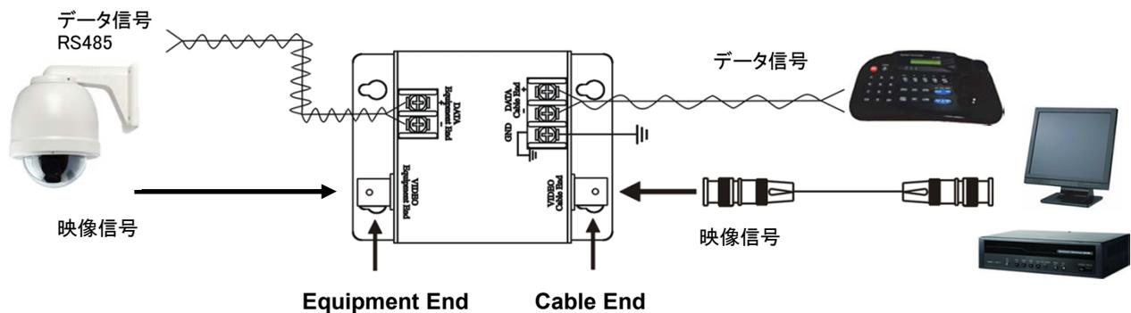
※カメラ側、モニター側 それぞれにサージプロテクターを設置し、機器を保護する場合は、「Equipment End」側に保護する機器を接続してください。
