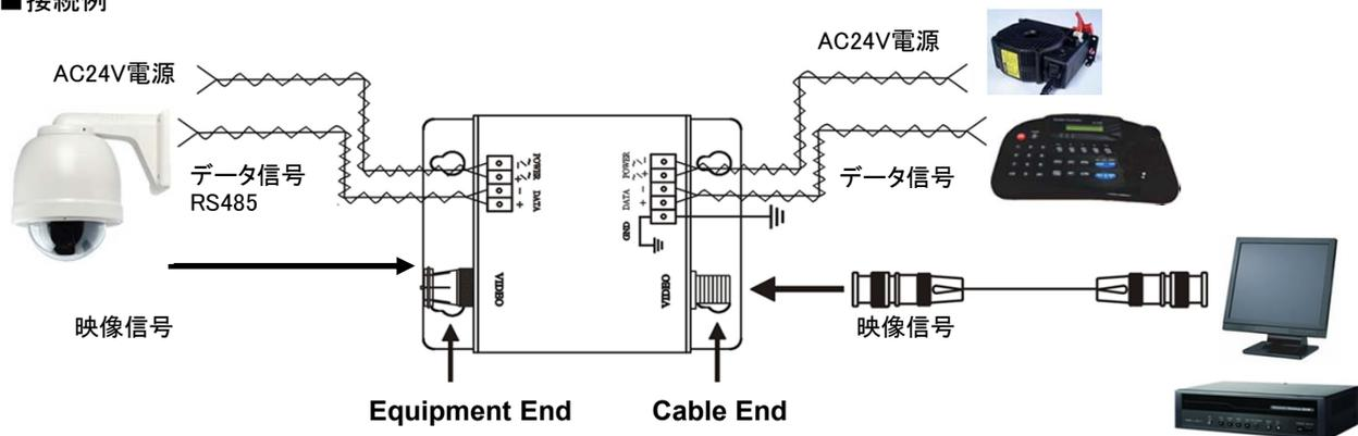
※カメラ側、モニター側 それぞれにサージプロテクターを設置し、機器を保護する場合は、「Equipment End」側に保護する機器を接続してください。
