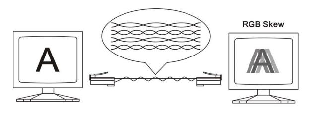
このゆがみを軽減するためには、以下のようにスキューアダプターを設置することを推奨します。 同梱のスキューアダプターを伝送距離の中間に1つと受信ユニットの前に1つ設置してください。
