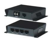
4 UTP - 1UTP(RJ45) ビデオ伝送用 集線ボックス 伝送可能距離 300m TMX-111VP、TMX-414Vなどと組合せて使用 電源を供給する場合は、伝送距離50m 映像伝送のみの場合、外部電源不要 PTCヒューズ(1.1A)内蔵 工事コストの削減に最適
