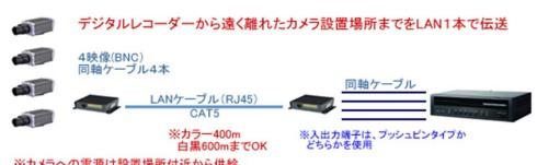
※カメラへの電源は設置場所付近から供給、 もしくは、別に通線。
