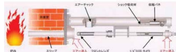
クォーツレンズを耐熱合金製のチューブ内に搭載。エアージャック、ショックアブソーバー、オートリトラクト機能を装備。液体を使用できない工場内でも、空気冷媒のみでの炉内監視可。
