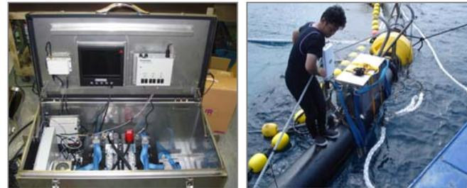
特型ステンレスBOXには、カメラ電源を始め、ズームレンズ操作、画像確認用TCL-8型モニター、TWX-2400ATP1型画像無線伝送送信機、105Ahバッテリー、バッテリーコントローラー、通電タイマーなどを収容しています。
